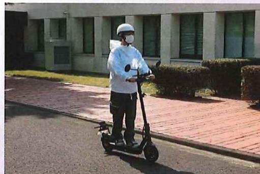
ものです。事故の原因は分かりませんが、右折したドライバーが電動キックボードを見て、自転車と同じスピードと判断して先に右折できると思ったのかもしれませんが。公道を走行できる電動キックボードは、スピードは自転車よりも速く、制動性能や旋回性能などはバイクよりも劣るなど、一般的には走行性能は自転車以上でバイク未満であると言われています。またタイヤが小径であるために、路面の凸凹や段差などに影響を受けやすく、立ち乗りのため重心が高く不安定な走行になりがちという一面があります。今まで、交通場面のなかで電動キックボードを目にする機会が少ないので、交差点を右折するときなどスピードを見誤らないようにしてください。電動キックボードを目にしたら、意外とスピードが出ていると思って慎重な運転を心がけましょう。
